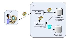
Fig. 2. Secure Version Control System.
